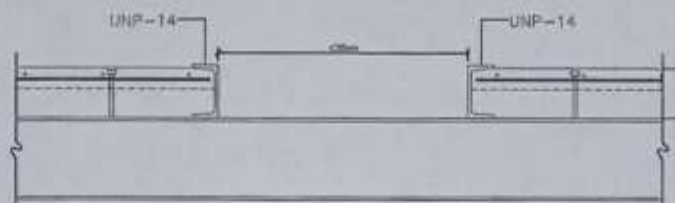
نحوه اجرای سوراخ در سقف عرشه فولادی
